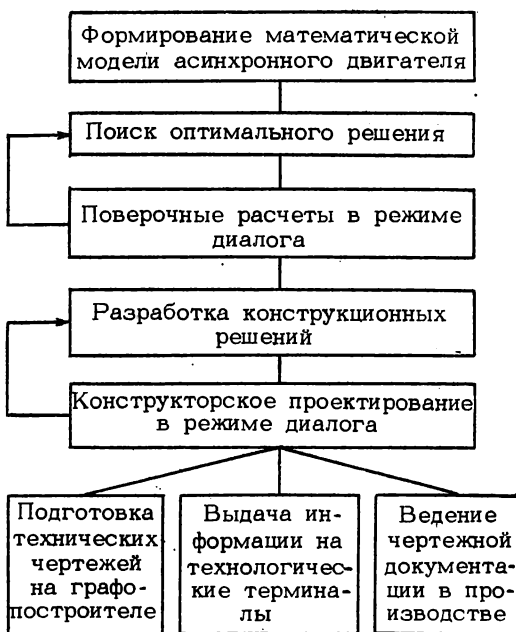
Рис. 23.44. Структурная схема проектирования асинхронных двигателей с использованием САПР
